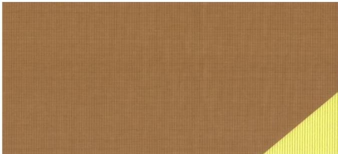
Стеклоткань PTFE премиум-серии Fiberflon, покрытые с одной стороны силиконовым клеем, чувствительным к высокой температуре и давлению. Желтая текстурированная разделительная прокладка из ПВХ наносится на клеевую поверхность для удобства нанесения. Некоторые области применения: легко снимаемая поверхность на машинах для термосваривания и упаковки, гладильном и прессовом оборудовании, покрытие сушильных цилиндров, облицовка лотков, снимаемая поверхность на инструментах для склеивания.
